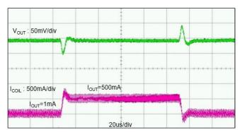
$\label{eq:cl242} XCL242$   $V_{IN}\!\!=\!\!3.8V,\,V_{OUT}\!\!=\!\!0.8V,\,I_{OUT}\!\!=\!\!1mA\!\Leftrightarrow\!\!500mA(tr,\!tf\!\!=\!\!1us),\,Ta\!\!=\!\!25^{\circ}\!C$
