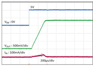
$\label{eq:cl242} XCL242$   $V_{IN}\!\!=\!3.6V,\,V_{OUT}\!\!=\!1.8V,\,V_{EN}\!\!=\!\!0V\!\!\Rightarrow\!\!5V,\,R_L\!\!=\!1.8k\Omega$
