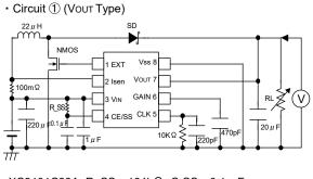
XC9101C33A R\_SS : 104k  $\Omega$  C-SS : 0.1  $\mu$  F XC9101C50A R\_SS : 138k  $\Omega$  C-SS : 0.1  $\mu$  F
